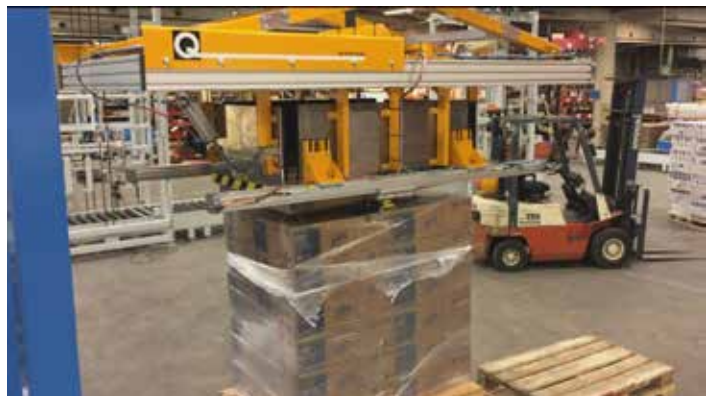
Portalen holder fast i lagene, der skal fjernes, mens knivene skærer folien over, så lagene kan fjernes.
