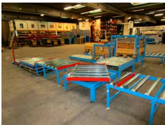
Anlægget blev testopstillet i Q-System inden afsendelse
